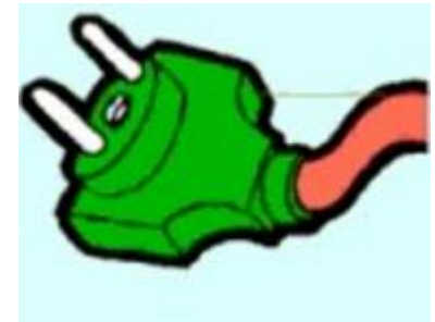
Falta de conexión a tierra
