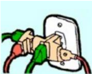
Uniones en mal estado – falta de aislación
